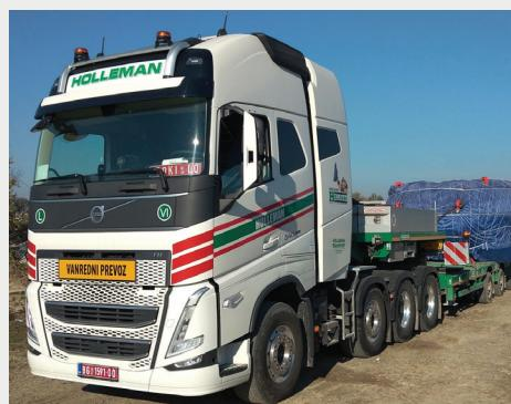
pa su iza kabine vertikalne bočne oplate s dizajnom koji potpuno oponaša oblik originalne kabine kao i druga dodatna oprema: dodatne boce za vazduh, boksovi sa rolo vratima za odlaganje materijala za vezivanje tereta, dodatni priključci za vozila koja vuku – specijalne poluprikolice.“
